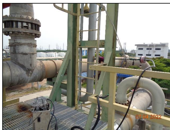
รูปที่ 4.1 การเก็บตัวอย่างคุณภาพอากาศจากแหล่งกำเนิด บริเวณ ปล่อง Ammonia Vent Scrubber
