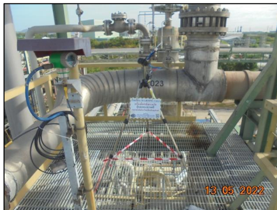
รูปที่ 4.5 การตรวจวัดปริมาณแอมโมเนีย บริเวณ Ammonia Vent Scrubber
