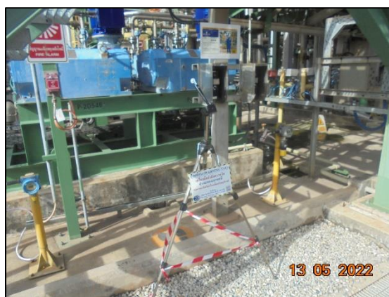
รูปที่ 4.6 การตรวจวัดปริมาณเอทิลีนออกไซด์ บริเวณ EO Pump
